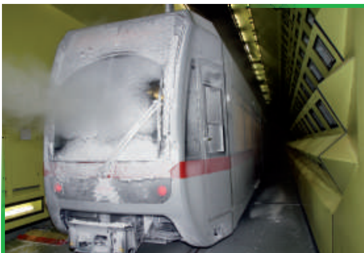
U6 „T1-Wien“ im Klima-Wind-Kanal der Testanlage Rail Tec Arsenal (RTA) in Wien
