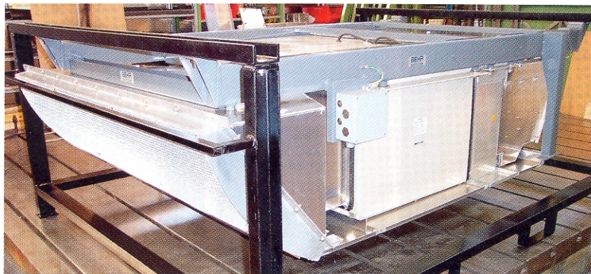
Abb. 12: Funktionsmuster für eine Transformatoranlage für einen Triebzug als Vorbild für die Lüftungsgeräuschminderung bei Klimaanlagen für O-Busse [3]
