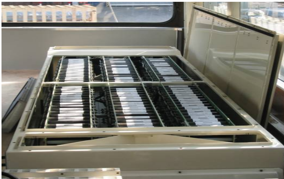
Abb. 2 Prismatische, seriengeschaltete Superkondensatoren aus dem Solinger Feldversuch. Technische Daten des Energiespeichers; Kondensatoren: 288 (in Serie); Kapazität: 2600 F/Kond; Nutzbare Energie: 500 Wh; Leistung: 270 kW; Maße: 3000*840*380 mm; Gewicht: 352 kg; Spannung: 300V bis 700V; Gesamtkapazität: 9,1F [12]
