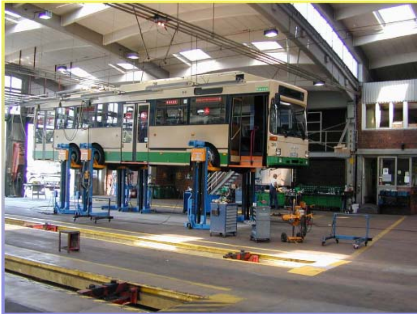
Abb. 26: Als Werkstatt reicht eine gemeinsame Werkstatt für Dieselbusse und O-Busse mit einem Dacharbeitsstand zur Wartung der Aufbauten [14]
