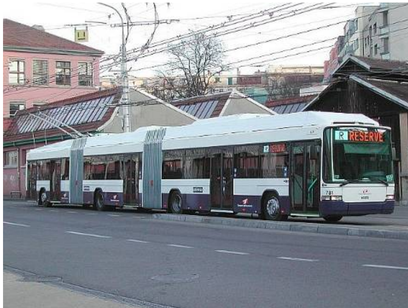
Abb. 10: Doppelgelenk O-Bus im Einsatz in Genf, Schweiz mit 24m Länge, 2 angetriebenen Achsen und fast 200 Plätzen (davon 66 Sitzplätze) [8]
