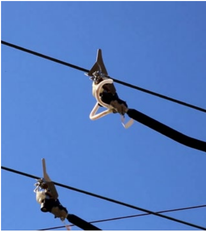
Stromabnehmerköpfe mit Andraht-hilfe: Kurz vor dem Andrahten
