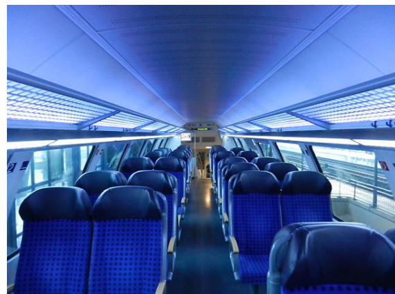
Ein neuer Doppelstockwagen mit bläulicher LED-Beleuchtung. Die Wagen sind weltweit die ersten ihrer Art, die die gesamte Beleuchtung mit LEDs realisieren.
