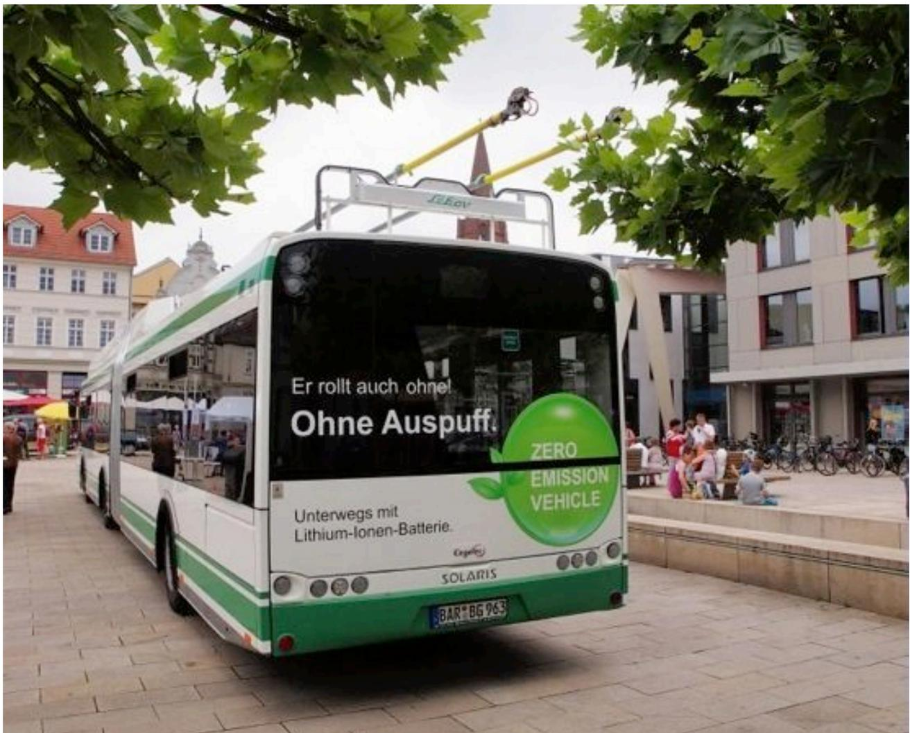
über zwei vollwertige elektrische Antriebssysteme. Mit Stolz kann er daher als Oberleitungshybridbus bezeichnet werden und ist der Erste seiner Art.
