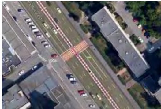
Figura 2.39 Exemple de benzi sonore folosite în apropiere de trecerea de pietoni de pe Calea București
