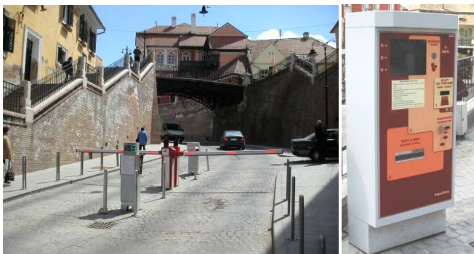
Figura 6-10 Afisarea numarului de locuri libere din parcare, prezenta barierei si a automatului electronic de plata
