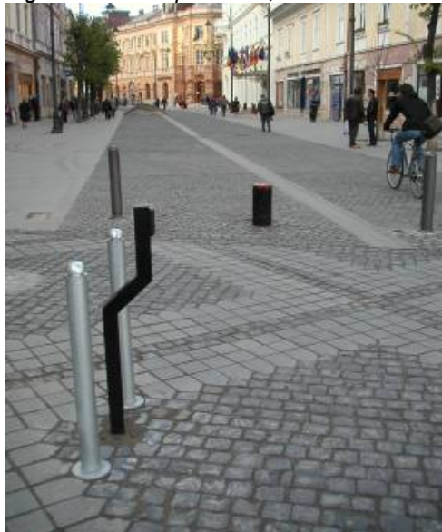
Figura 6-9 Zona pietonala, sistem de control al accesului selectiv cu stalpi retractabili
