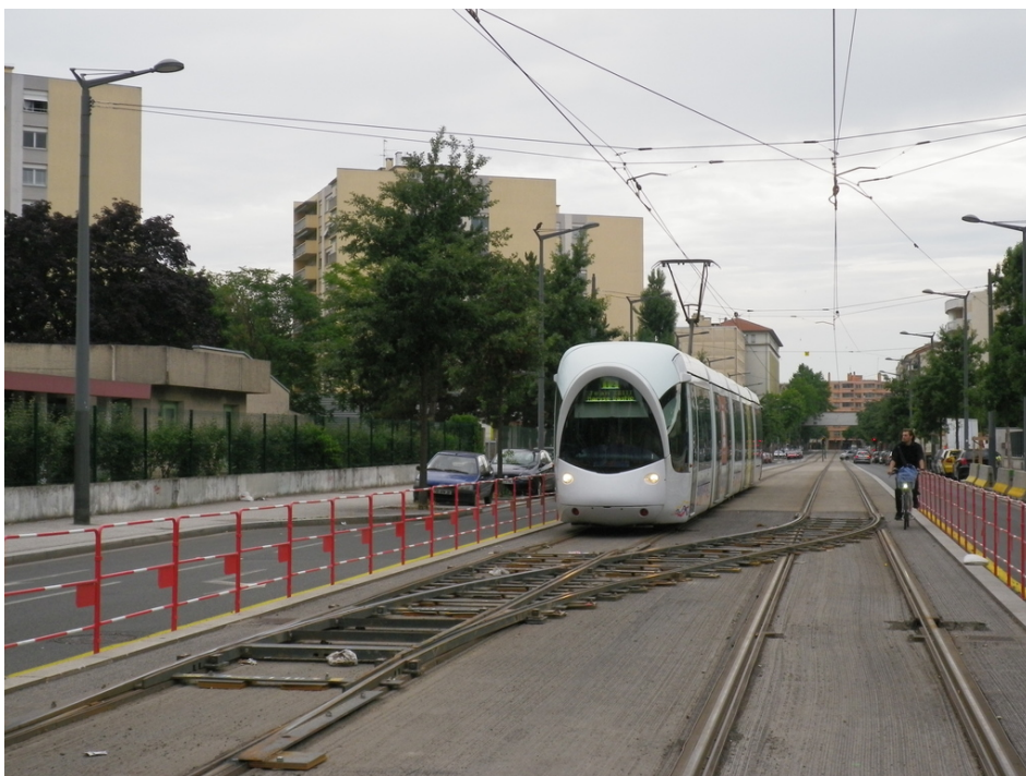
Les rames de T2 font leur terminus à la station Jean XIII – Maryse Bastié à l'aide d'un aiguillage californien.
