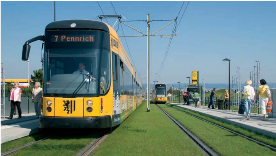
Die „ideale“ DVB-Haltestelle: barrierefrei, mit Fahrgastunterstand, Sitzgelegenheiten, passender Beleuchtung, Fahrplan und elektronischer Abfahrtstafel sowie einer Abgrenzung zum Straßenverkehr
