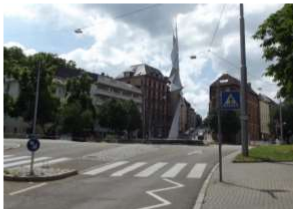
Fig.U43 Refugii intermediare pentru sporirea confortului și siguranței traversării (cu rol și de "ecluză", pentru încetinirea vitezei automobilelor (Stuttgart)
