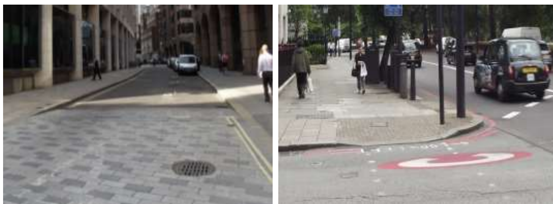
Fig.U41 Tipuri de amenajări pentru eliminarea diferențelor de nivel pe circulațiile pentru DNM, la traversări: a. ridicarea carosabilului, pe străzi secundare, cu efect de calmare a traficului; b.
