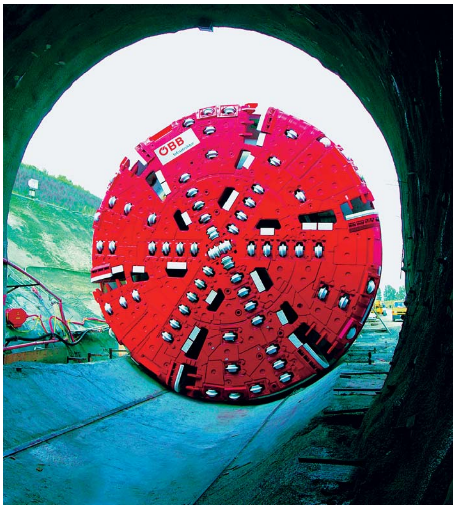
BOHRKOPF. 10 Meter im Durchmesser, 2.500 Tonnen schwer und 10.000 PS stark
