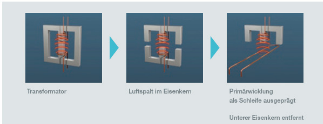
Abbildung 2-11: Funktionsprinzip induktive Übertragung 15
