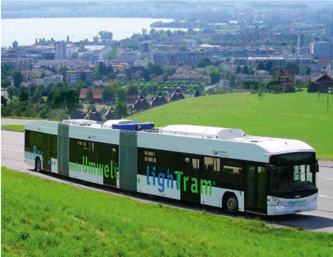
Abbildung 2-2: Doppelgelenkbus mit Hybridantrieb, hier als LightTram 4
